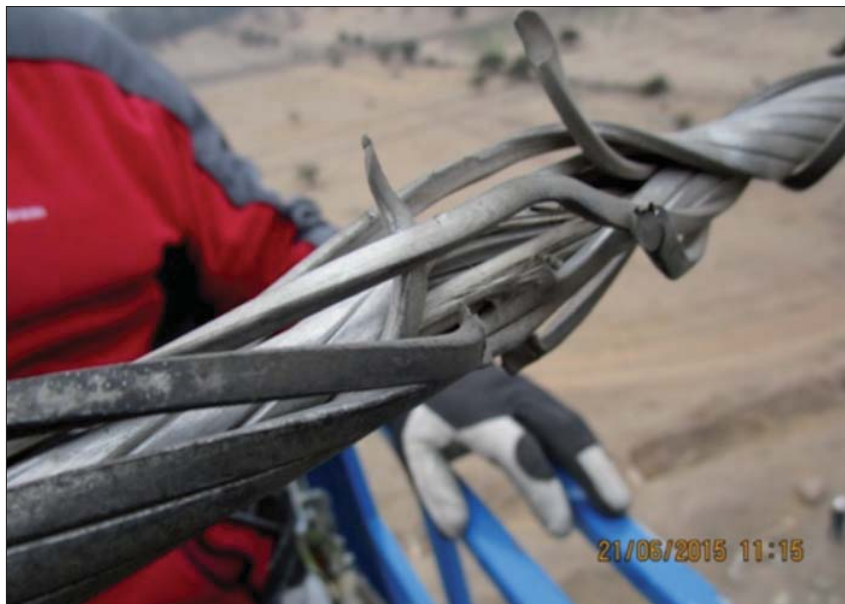
Figura 7 ACCC Conductor con anima danneggiata dopo uno colpo di fucile
